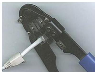
7. Finalizando así la construcción de un extremo del cable. Debe repetirse el procedimiento para colocar otro conector RJ45 del otro extremo del cable.
