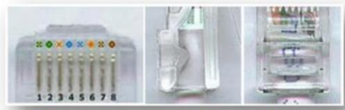
6. Utilice las pinzas engarzadoras y apriete el conector con suficiente fuerza como para forzar los contactos a través del aislamiento en los hilos, completando así el camino conductor como se visualiza a continuación:
