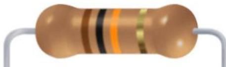
Su valor nominal es de \_\_\_\_\_  $\Omega$  con un intervalo de tolerancia de \_\_\_\_\_ %. Por lo que su valor puede estar entre \_\_\_\_\_  $\Omega$  y \_\_\_\_\_  $\Omega$ .
